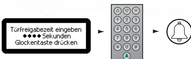
Dies ist die Zeitspanne, in der das Schloss nach dem Drücken der Türöffnungstaste auf einem Monitor freigegeben bleibt. Dieser Wert kann nur geändert werden, wenn er nicht von Net2 verwaltet wird. Dieser Wert darf nur geändert werden, wenn er nicht von Net2 oder Paxton10 verwaltet wird.
